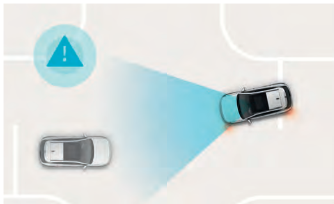
Freinage d'urgence autonome avec fonctions intersection et croisement.
