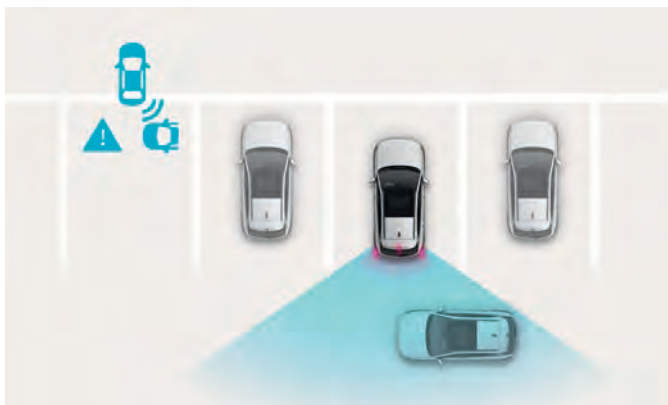
Alerte de circulation transversale à l'arrière avec fonction freinage.
